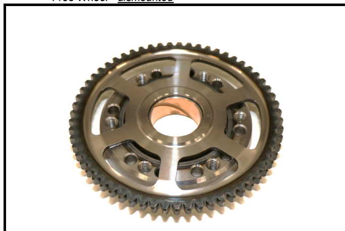
C16-2) Roue libre - déposée Free Wheel - dismounted
