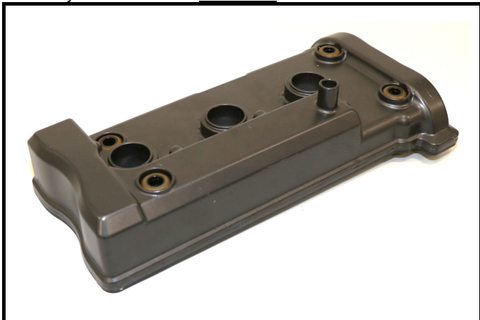
C1-3) Couvre culasse - déposé Cylinderhead cover - dismounted
