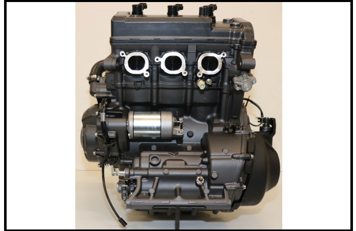
C1-4) Couvre culasse - déposé Cylinderhead cover - dismounted
