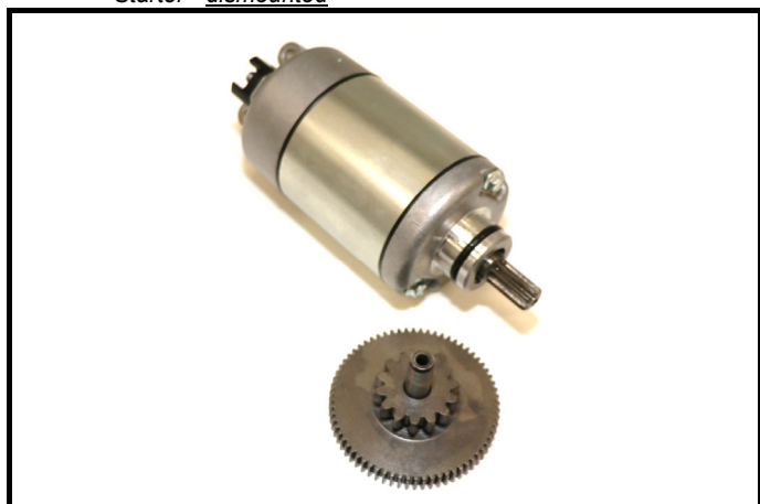
C16-1) Démarreur - déposé Starter - dismounted
