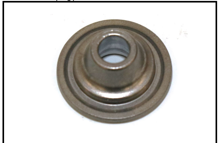
C11-6) Coupelle de ressort admission - déposée Intake spring plate - dismounted
