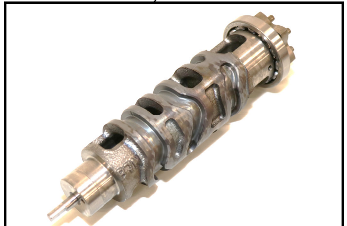
F9-11) Assemblage du barillet Selector barrel assembly
