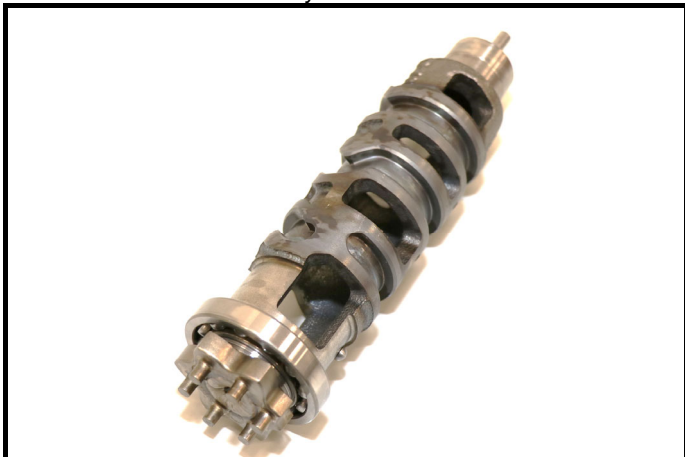
F9-10) Assemblage du barillet Selector barrel assembly
