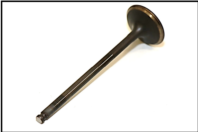
C12-1) Soupape échappement - déposée Exhaust valve - dismounted
