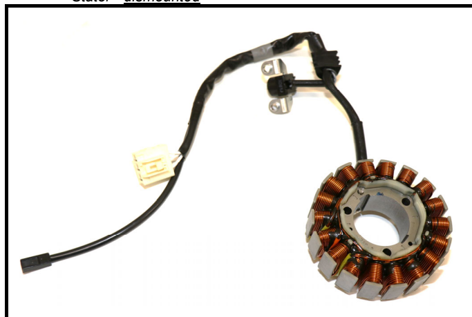
C15-2) Stator - déposé Stator - dismounted
