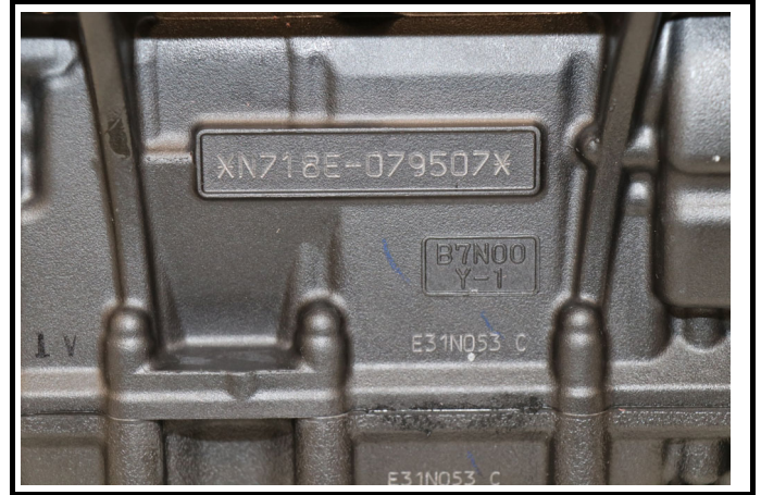
C3-8) Numéro de série sur le bloc Serial number on engine block
