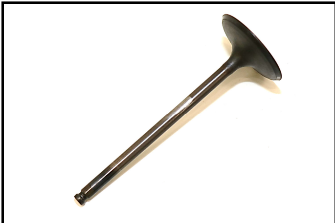
C11-5) Soupape admission - déposée Intake valve - dismounted
