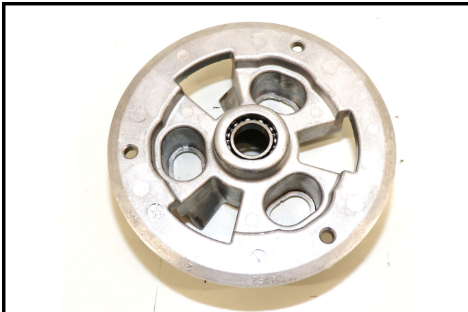
C17-7) Came d'embrayage – vue de face Clutch cam – face view
