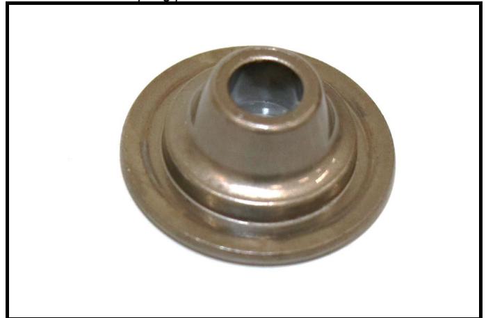
C12-2) Coupelle de ressort échappement - déposée Exhaust spring plate - dismounted
