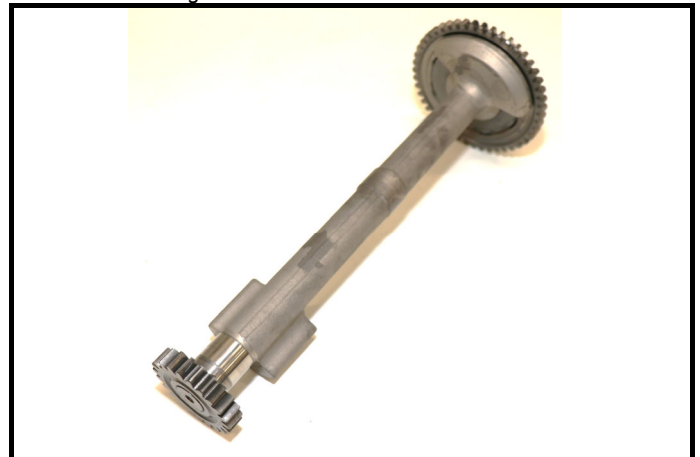
C3-10) Arbres déquilibrage - démontés Balancing shafts - dismantled
