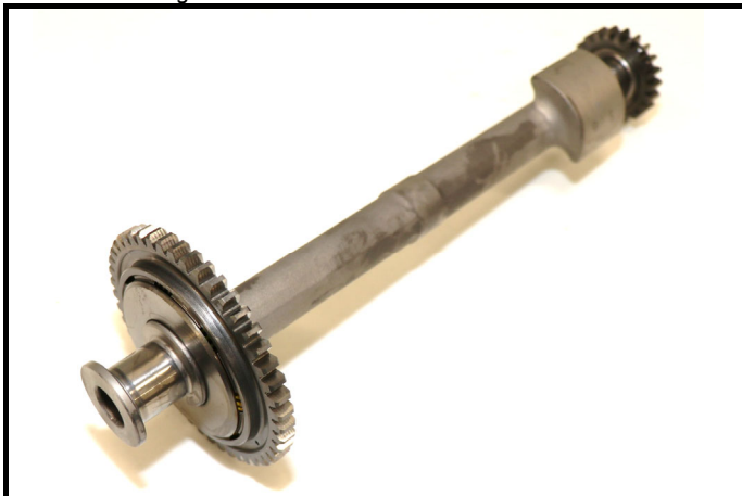
C3-9) Arbres déquilibrage - démontés Balancing shafts - dismantled
