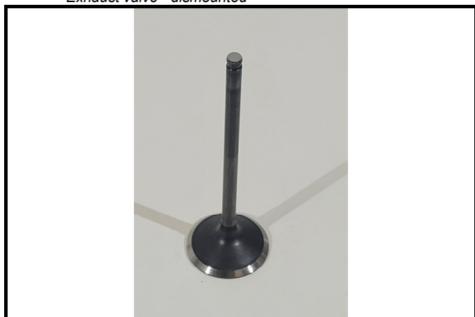
C12-1) Soupape échappement - déposée Exhaust valve - dismantled
