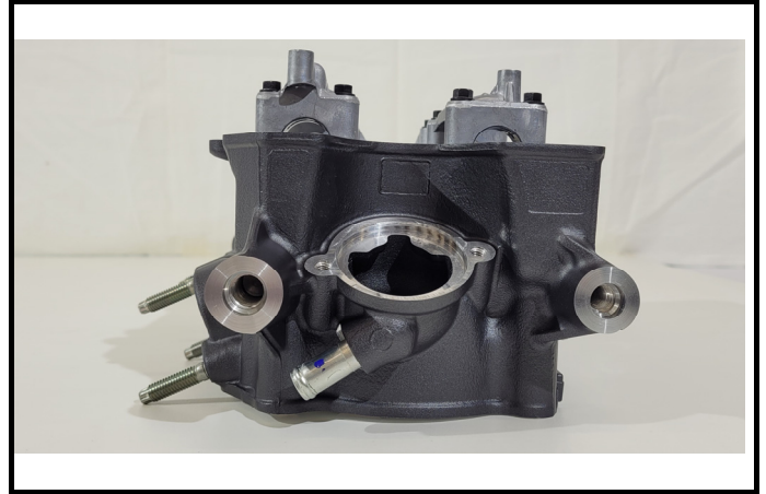
C8-6) Culasse nue vue côté droit Bare cylinderhead seen from right hand side
