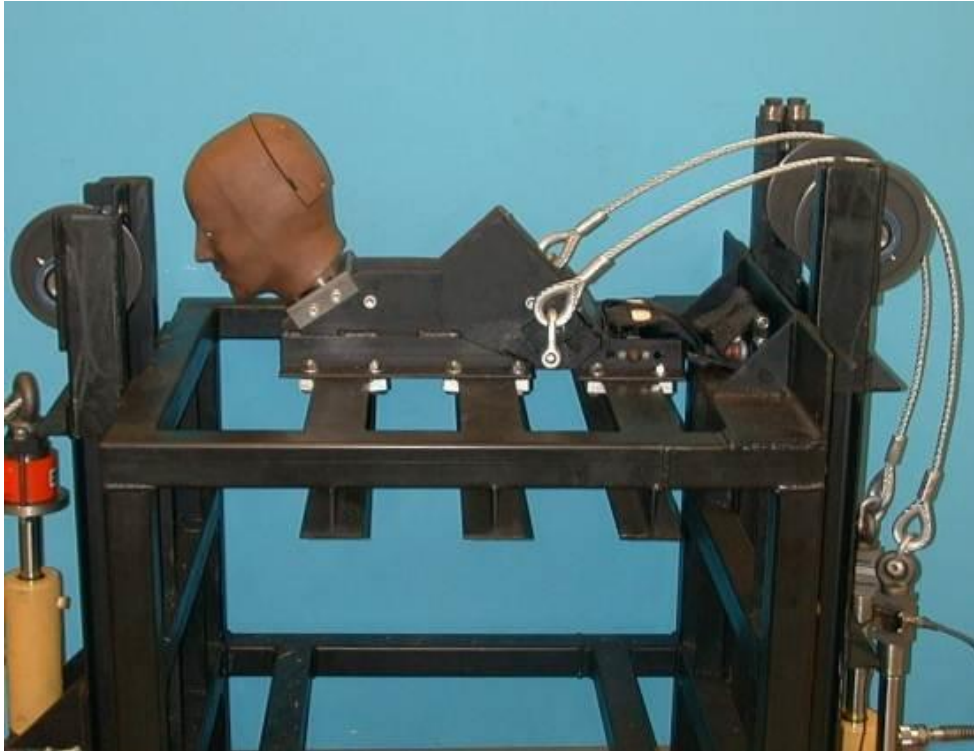
Figure B1. Appareil d'essai des Fixations de Casque M6 Figure B1. Apparatus for testing Helmet-M6-Terminals
